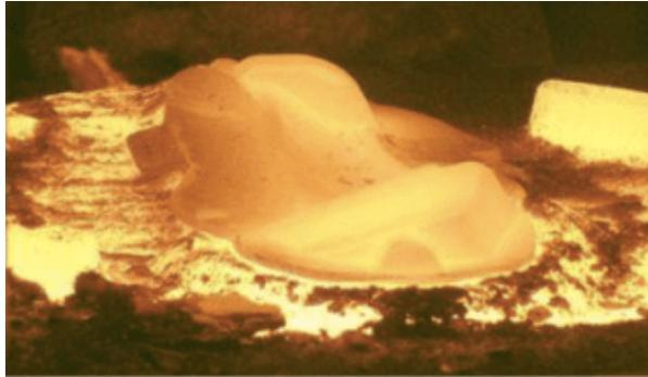
Fig. 8 Blade in isothermal die
